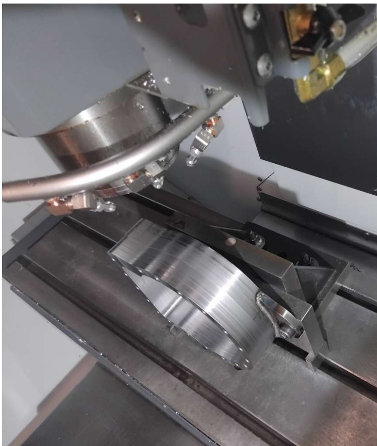
Figure 54 Image de l'équerre d'usinage sur lequel se monte le montage d'usinage (vue 2)
