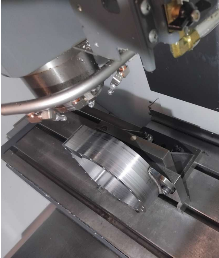
Figure 41 mise en position de la pièce dans la machine (vue 1)
