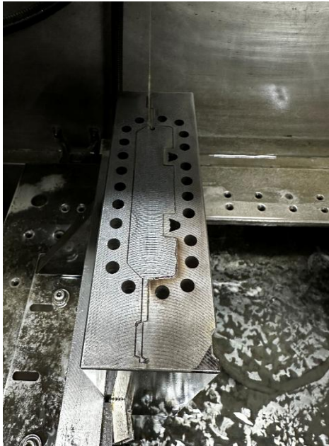
Calibreur (1) 3 pour CA24066 en cours d'usinage en électroérosion (6) , après ébauche
