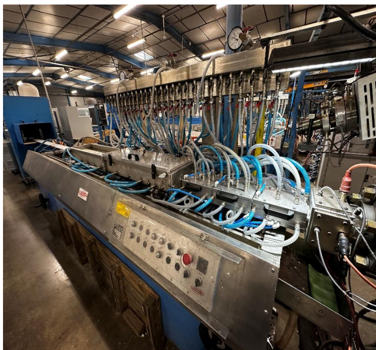
Extrudeuse en cours de production
